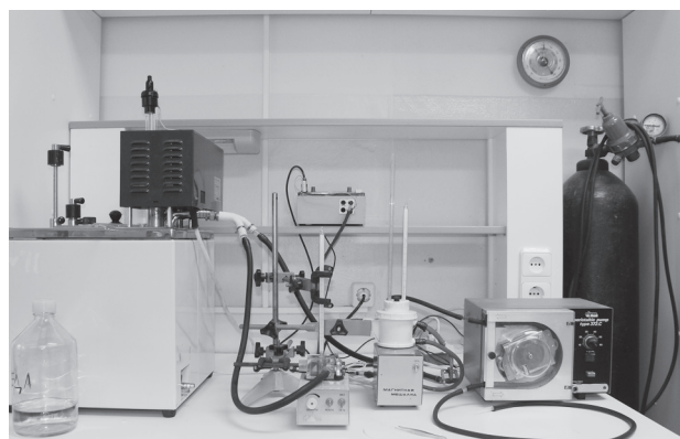
Рис. 2. Установка для точного измерения потребления кислорода в малых объемах инкубационных сред
